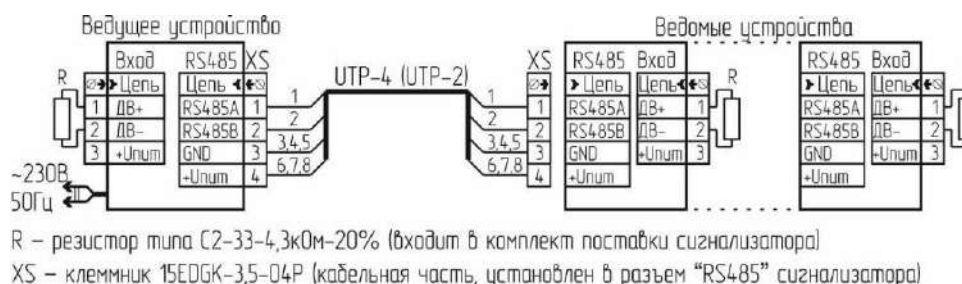
Рисунок 23 – Схема для программирования адресов системы САКЗ-МК-1Е
